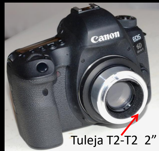
Mocowanie sitki dyfrakcyjnej 500 linii/mm w filtrze UV 40,5mm, do matrycy ~ 45mm
